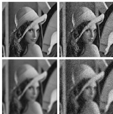
รูปที่ 3.14 ตัวอย่างภาพ Lena ที่ใช้ในการทดลอง ภาพซ้ายบนจะเป็นภาพที่ถูกทำให้พร่ามัวด้วย averaging mask ขนาด 3x3 ด้วย slight additive noise ที่มี STD = 5 โดยภาพขวาบน มี STD = 30 และภาพซ้ายล่างจะเป็นภาพที่ถูกทำให้พร่ามัวด้วย averaging mask ขนาด 9x9 ด้วย slight additive noise noise ที่มี STD = 5 โดยภาพขวาล่างมี STD = 3
