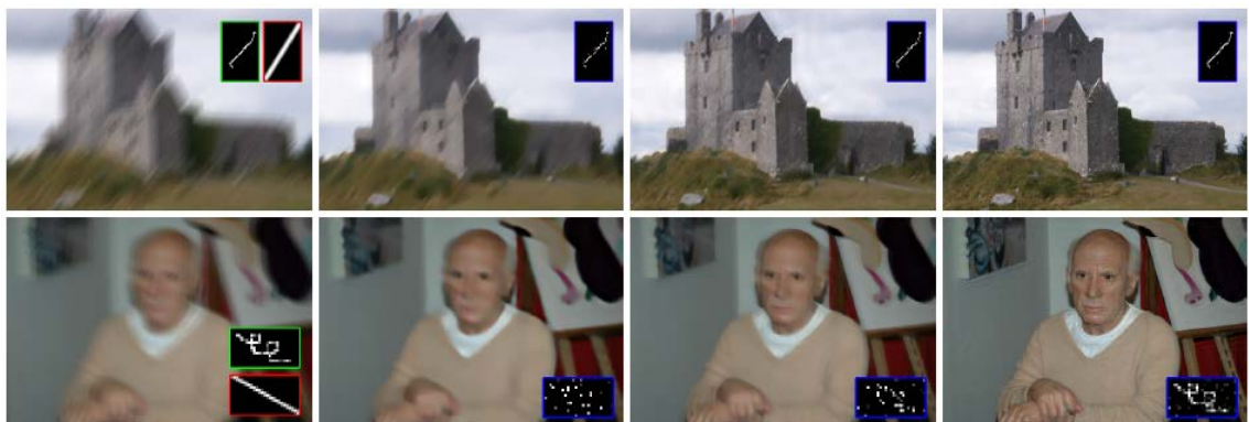
รูปที่ 3.32 ผลการทำซ้ำเพื่อประมาณค่า PSF ของ Q. Shan รูปแนวตั้งแถวที่ 1 แสดงภาพที่พัวรั่มัว รูปแนวตั้งแถวที่ 2 แสดงการทำซ้ำครั้งที่ 1 รูปแนวตั้งแถวที่ 3 แสดงการทำซ้ำครั้งที่ 6 รูปแนวตั้งแถวที่ 4 แสดงการทำซ้ำครั้งที่ 10
