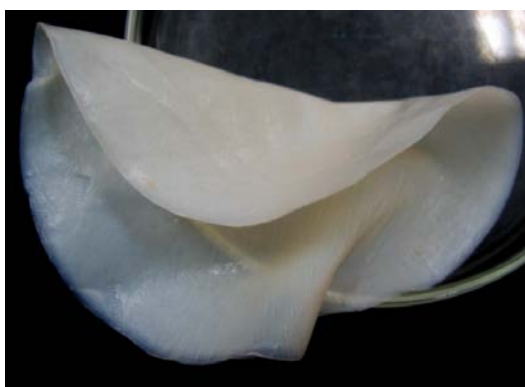
ภาพที่ 4.3 ลักษณะของแผ่นเซลลูโลสที่ผ่านการทำให้บริสุทธิ์ โดยแช่ในสารละลายโซเดียมไฮดรอกไซด์ ความเข้มข้นร้อยละ 1.0 จากนั้นต้มในน้ำกลั่น 30 นาที รีดน้ำออกด้วยเครื่องอัดรีดน้ำ จะได้แผ่นเซลลูโลสที่มีความหนาเฉลี่ย เท่ากับ 0.65 มิลลิเมตร สำหรับนำมาใช้ร่วมกับสารสกัดจากพืชที่คัดเลือกได้
