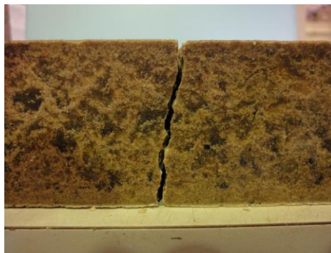
(c) การวิบัติของตัวอย่างภายใต้แรงคด
