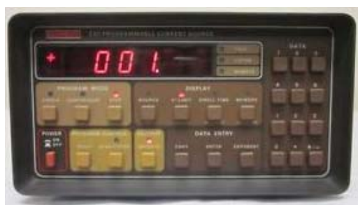
รูป 2.20 แสดง Constant Current Source ที่มา: วตาพร ลีลาพตะ (2553). การพัฒนาระบบการวัดสมบัติของสารกึ่งตัวนำด้วย 4-Point Probe, หน้า 22
