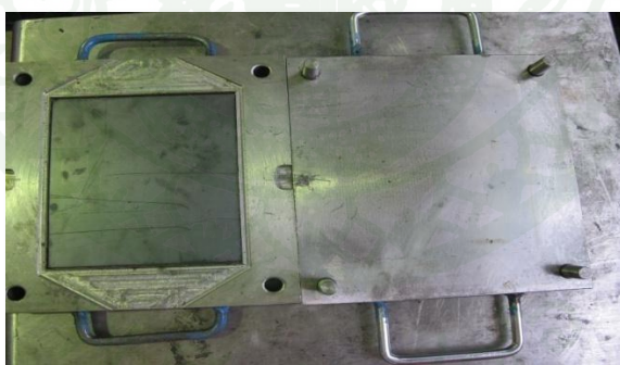
ภาพที่ 23 แม่พิมพ์อัดขึ้นรูปแบบโอเวอร์โมลด์ที่ใช้สำหรับขึ้นรูปชิ้นงานทดสอบ
