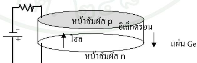
ภาพที่ 6 โครงสร้างหัววัดเจอร์มาเนียมความบริสุทธิ์สูงชนิดเพลนนา
