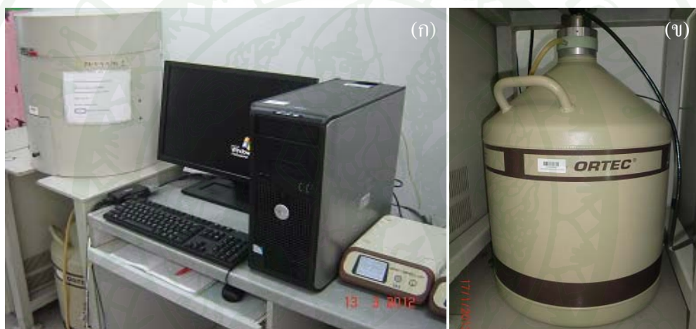
ภาพที่ 17 ระบบวัดรังสีแกมมา หัววัดเจอร์มาเนียมความบริสุทธิ์สูง (ก) และถังบรรจุไนโตรเจนเหลว (ข)
