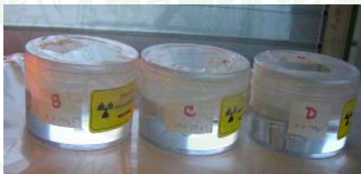
ภาพที่ 22 สารละลายมาตรฐานซีเซียม-134 ความเข้มข้น 2.5, 5.0 และ 7.5 MBq L -1
