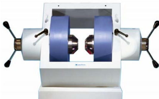
ภาพที่ 13 เครื่องกำเนิดแม่เหล็กไฟฟ้า (EM4-HVA; Lake Shore Cryogenics)
