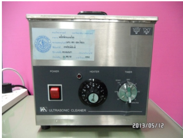
ภาพที่ 16 เครื่องล้างความถี่สูง (CMT-50H; Storehouse Intertrade Ltd.)
