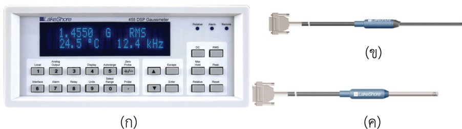
ภาพที่ 14 (ก) เครื่องวัดสนามแม่เหล็ก (455DSP; Lake Shore Cryogenics) และ (ข) หัววัดสนามแม่เหล็กในแนวตั้งฉากแบบปรากฏการณ์ฮอลล์ (HMMT-6J04-VR; Lake Shore Cryogenics) (ค) หัววัดสนามแม่เหล็กในแนวแกนแบบปรากฏการณ์ฮอลล์ (HMMA-2502-VR; Lake Shore Cryogenics)
