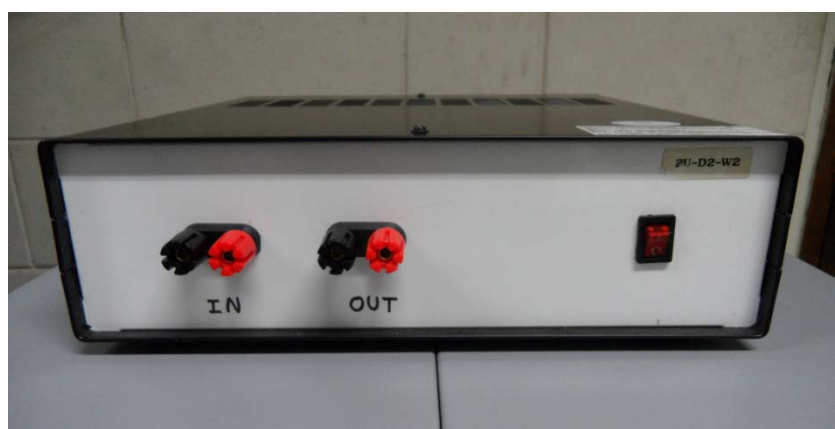
ภาพที่ 29 เครื่องขยายกระแสไฟฟ้าสำหรับสร้างสนามแม่เหล็กเกรเดียนท์สลับ
