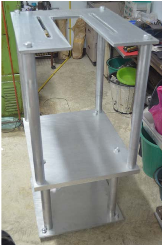
ภาพที่ 37 ภาพชั้นวางแม่เหล็กที่สร้างจากอลูมิเนียม
