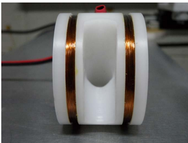
ภาพที่ 26 ภาพขดลวดสำหรับสร้างสนามแม่เหล็กเกรเดียนท์
