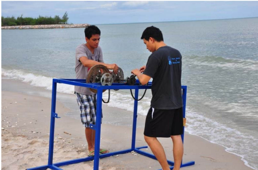
รูปที่ ข.4 ประกอบเครื่องผลิตพลังงานไฟฟ้าจากคลื่นชายฝั่งทะเลเพื่อทดลองในสถานที่จริง
