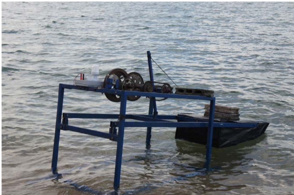
รูปที่ ข.8 เพิ่มน้ำหนักทุ่นเพื่อหาน้ำหนักของทุ่นที่มีประสิทธิภาพการทำงานที่ดีที่สุด
