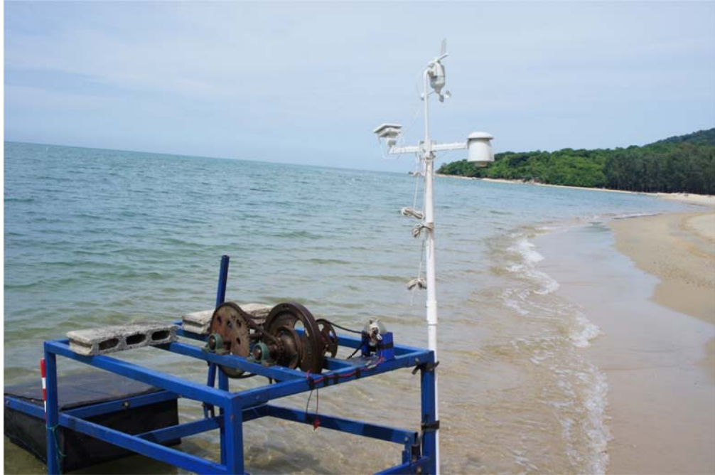
รูปที่ ข.5 ติดตั้งเครื่องในสถานที่ทดลองจริง พร้อมกับเครื่องวัดความเร็วลม
