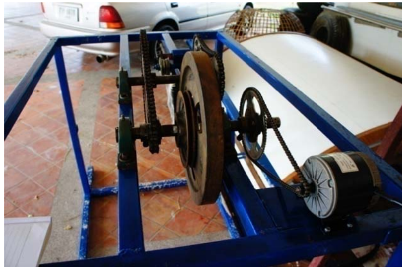
รูปที่ 3.10 ชุดเฟืองอัตราทดที่ประกอบเสร็จเรียบร้อยแล้ว
