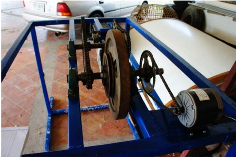
รูปที่ 3.17 การวางมอเตอร์ผลิตไฟฟ้าบน โครงสร้าง
