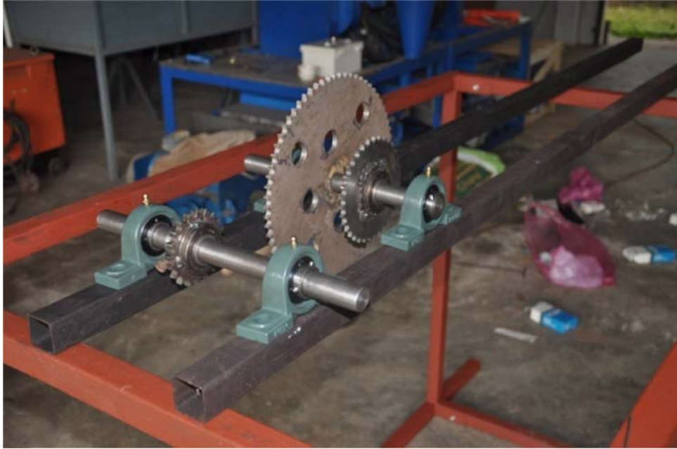
รูปที่ 3.15 การวางชุดเฟืองทดบน โครงสร้าง
