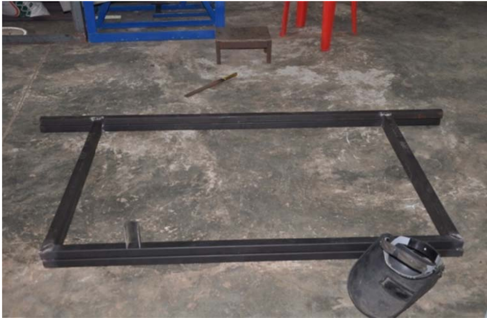
รูปที่ 3.13 ฐานโครงสร้างเครื่องผลิตไฟฟ้า
