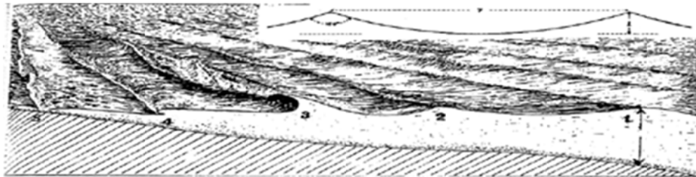
รูปที่ 2.2 แสดงการเปลี่ยนแปลงของคลื่นเมื่อเคลื่อนที่เข้าหาฝั่ง [4]
