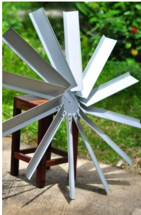
รูปที่ 3.9 ใบพัดที่เคลื่อนที่จำนวน 12 ใบ
