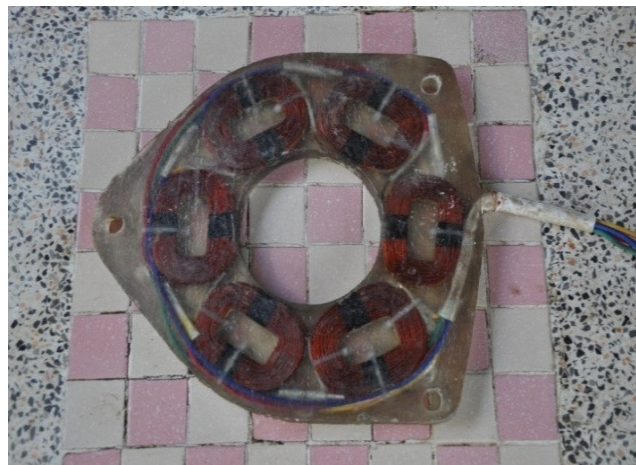
รูปที่ 3.12 หล่อเรซินขดลวดขุดสเตเตอร์
