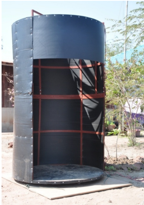
รูปที่ 3.23 ปล่องทรงกระบอก
