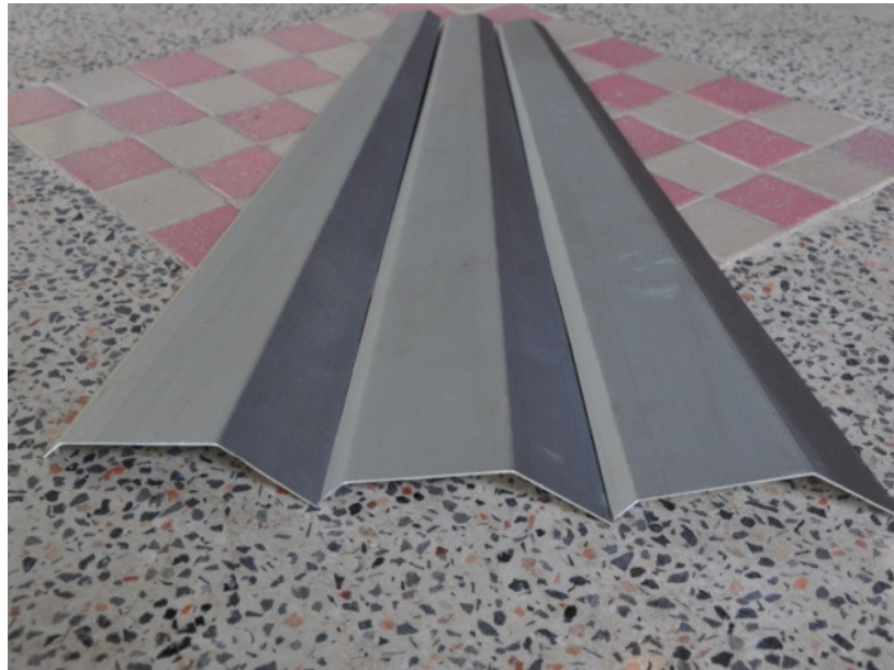
รูปที่ 3.6 ใบพัดปรับทิศทางลมทำมุม 20^\circ
