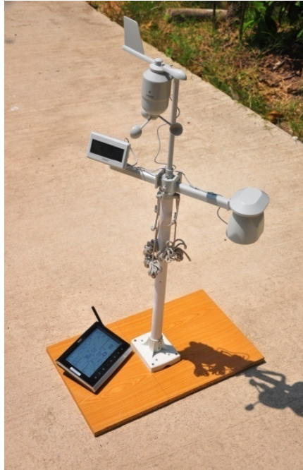
รูปที่ 3.19 เครื่องวัดอุณหภูมิและความเร็วลม
