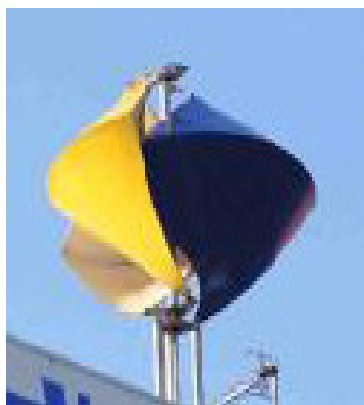
รูปที่ 2.2 ลักษณะกังหันลมแกนหมุนแนวตั้งชนิดขับเคลื่อนด้วยแรงดูด[1]
