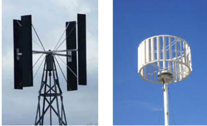
รูปที่ 2.3 ลักษณะกังหันลมแกนหมุนแนวตั้งชนิดขับเคลื่อนด้วยแรงยก[1]
