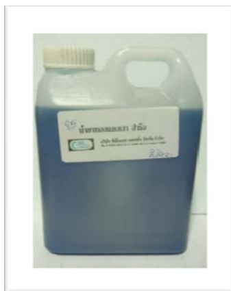
ภาพที่ 2.11 น้ำยาชุบทองแดงกรด (ทองแดงเงา)
