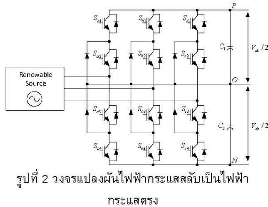
วงจรแปลงผันไฟฟ้ากระแสสลับเป็นไฟฟ้ากระแสตรงแบบสามระดับประกอบด้วยไอจีบีที (IGBT) ไดโอด และตัวเก็บประจุ  $C_1, C_2$  ที่ DC-Link ดังรูปที่ 2
