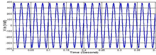
รูปที่ 6 แรงดันของเฟส AB ทางด้านขาเข้า
