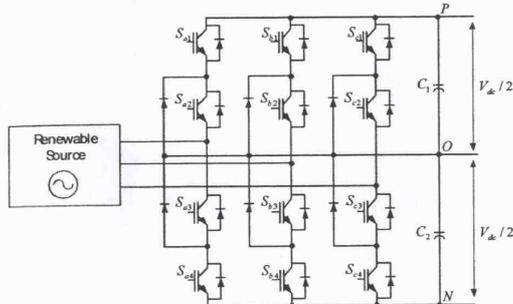
รูปที่ 2 วงจรแปลงผันไฟฟ้ากระแสสลับเป็นไฟฟ้ากระแสตรง
