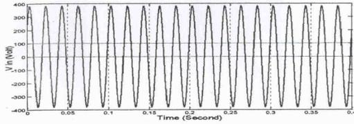
รูปที่ 6 แร่งดันของเฟส AB ทางด้านขาเข้า
