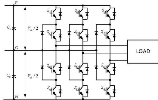
รูปที่ 3 วงจรแปลงผันไฟฟ้ากระแสตรงเป็นไฟฟ้ากระแสสลับ
