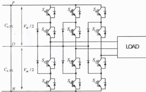
รูปที่ 3 วงจรแปลงผันไฟฟ้ากระแสตรงเป็นไฟฟ้ากระแสสลับ
