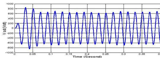
รูปที่ 9 แรงดันของเฟส AB ทางด้านขาออก
