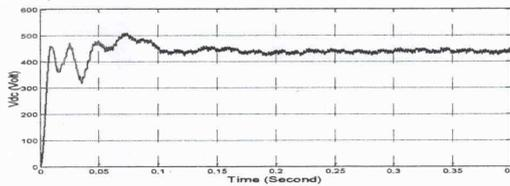
รูปที่ 8 แร่งดันที่ DC-Link
