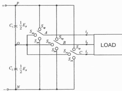
รูปที่ 4 แบบจำลองอย่างง่ายของวงจรแปลงผันไฟฟ้ากระแสตรงเป็นไฟฟ้ากระแสสลับ
