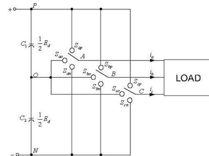
รูปที่ 4 แบบจำลองอย่างง่ายของวงจรแปลงผันไฟฟ้ากระแสตรงเป็นไฟฟ้ากระแสสลับ
