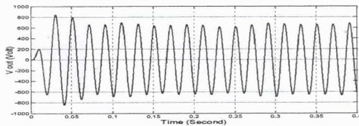
รูปที่ 9 แร่งดันของเฟส AB ทางด้านขาออก
