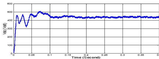
รูปที่ 8 แรงดันที่ DC-Link
