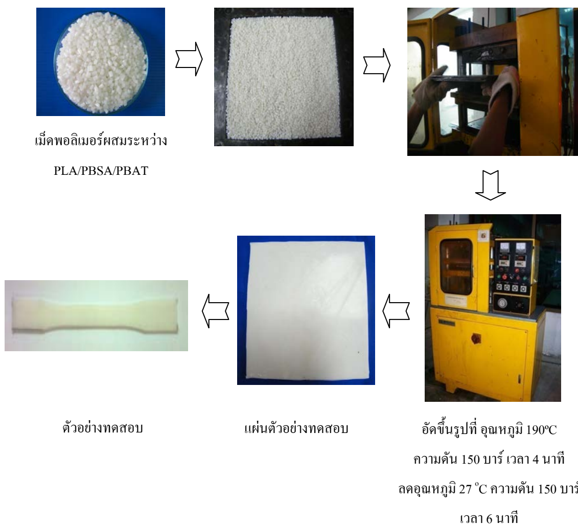
รูปที่ 3.3 ขั้นตอนการอัดขึ้นรูปพอลิเมอร์ผสมระหว่าง PLA/PBSA/PBAT ด้วยเครื่องอัดขึ้นรูป
