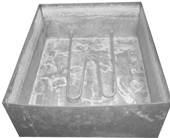
รูปที่ 3.12 อ่างให้ความร้อนที่ทำการติดตั้ง (Heater) แล้ว
