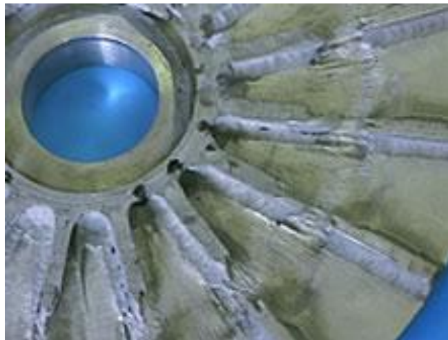
รูปที่ 2.11 การกัดกร่อนแบบรูพรุน [9]
