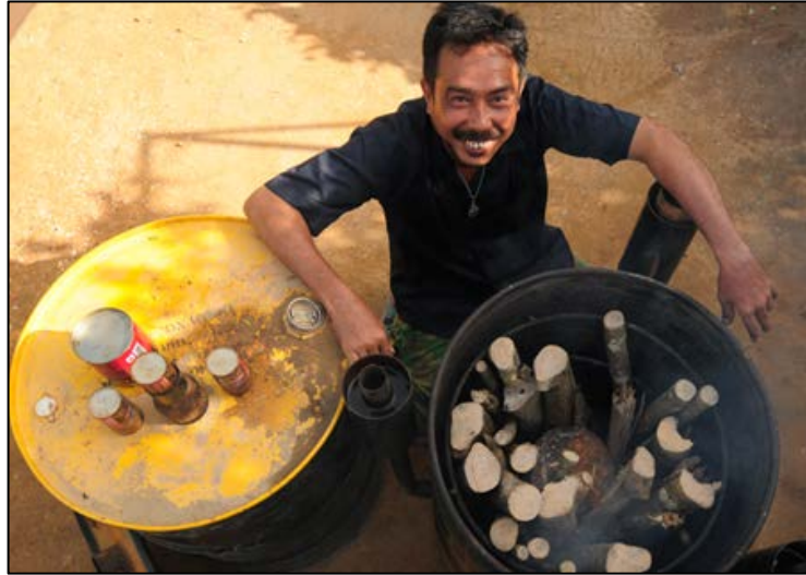
รูปที่ 4.12 เตาเผาถ่าน 200 ลิตร แบบขึ้นร่นซูเปอร์ 84 ที่มา: รักษ์ป่า สร้างคน 84 ตำบลวิถีพอเพียง (2555)
