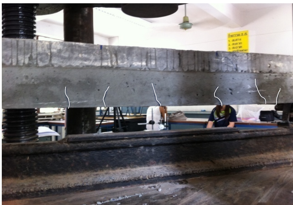
รูปที่ 4.4 ตัวอย่างลักษณะการพังทลายของตัวอย่างคานคอนกรีตเสริมเหล็กควบคุมสภาพผิวเรียบที่ถูกขยายหน้าตัดด้วย HS-FRC
