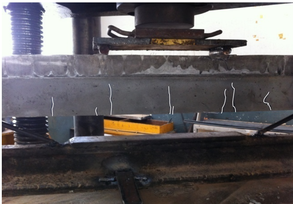
รูปที่ 4.6 ตัวอย่างลักษณะการพังทลายของตัวอย่างคานคอนกรีตเสริมเหล็กควบคุมสภาพผิวขรุขระที่ ถูกขยายหน้าตัดด้วย HS-FRC
