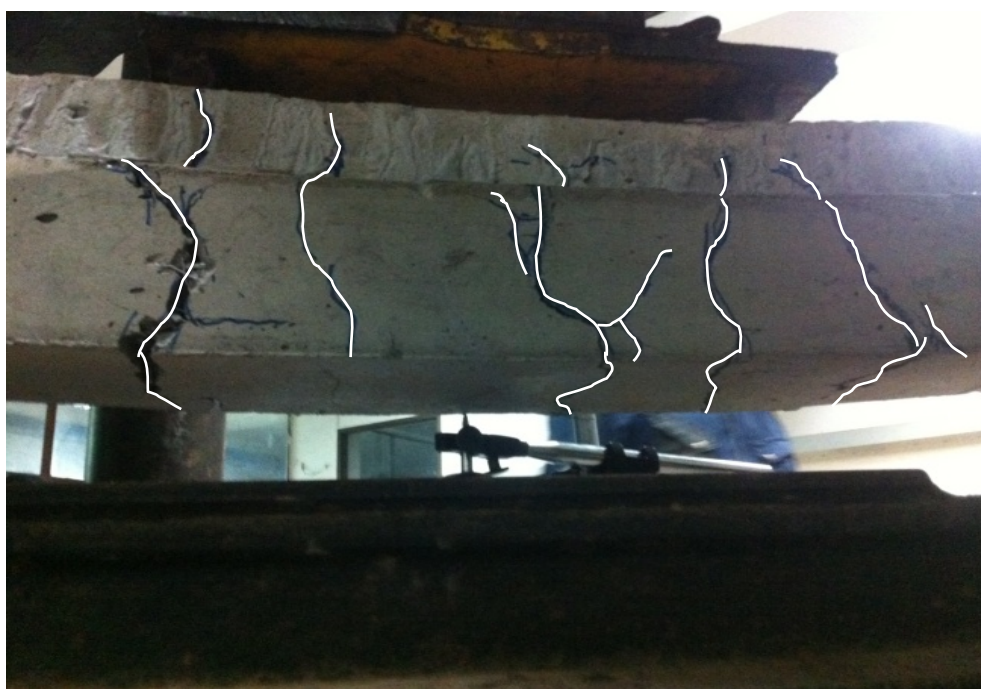
รูปที่ 4.8 ตัวอย่างลักษณะการพังทลายของตัวอย่างคานคอนกรีตเสริมเหล็กควบคุมสภาพผิวขรุขระที่ ถูกขยายหน้าตัดด้วย HS-FRC
