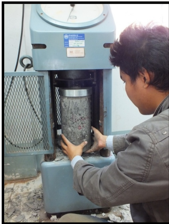
รูปที่ 4.1 การทดสอบกำลังรับแรงอัดของตัวอย่างคอนกรีตรูปทรงกระบอก
