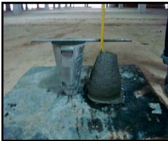
รูปที่ 3.12 การทดสอบค่าความยุบตัว (Slump Test)
