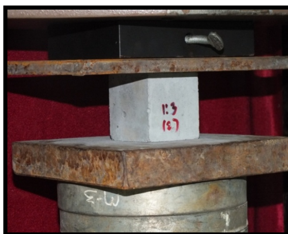
รูปที่ 3.15 การทดสอบกำลังรับแรงอัดของตัวอย่างมอร์ตาร์
