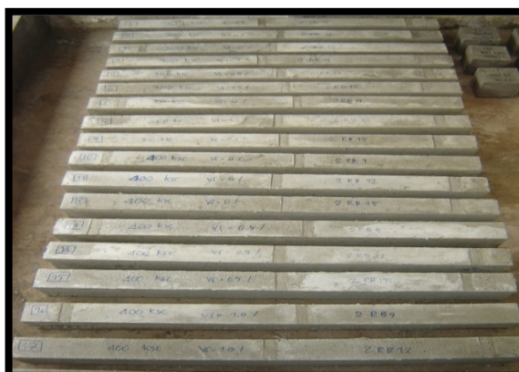
รูปที่ 3.16 ตัวอย่างคานคอนกรีตเสริมเหล็กควบคุม
