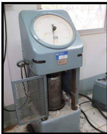
รูปที่ 3.14 การทดสอบกำลังรับแรงอัดของตัวอย่างคอนกรีตรูปทรงกระบอก
