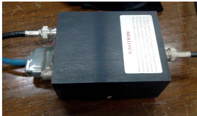
รูปที่ 3.4 วงจรขยายส่วนหน้า Canberra รุ่น 2005
