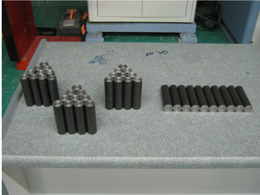
รูปที่ ค.1 เตรียมชิ้นงาน เหล็ก S 50 C ขนาดเส้นผ่านศูนย์กลาง 25.4 มม.ยาว 100 มม. เจาะรูขั้นศูนย์ 1 ด้าน
