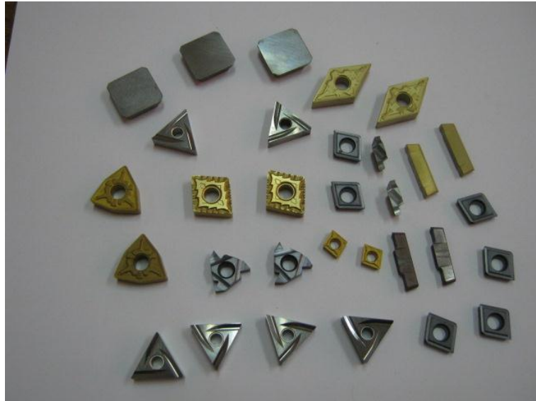
รูปที่ 2.6 แสดงตัวอย่างของเม็ดมีดกลึงอินเสิร์ต
