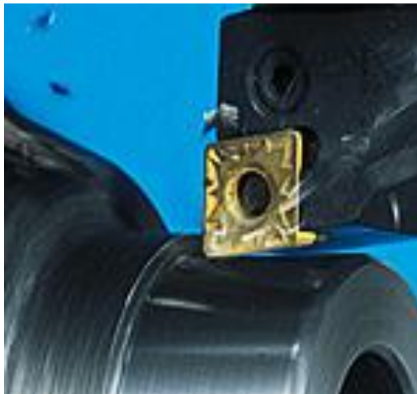
รูปที่ 2.2 แสดงการกลึงปอกเหล็กกล้าคาร์บอนปานกลางด้วยมีดเซรามิค [6]
