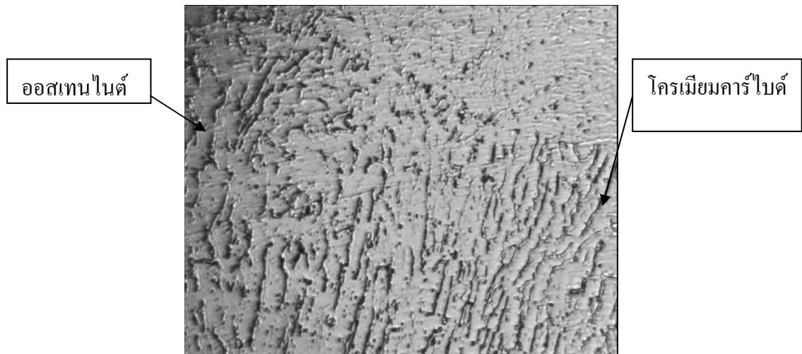
รูปที่ 4.11 แสดงลักษณะโครงสร้างจุลภาคบริเวณกระทบร้อน ด้านเหล็กกล้าไร้สนิม AISI 304 ชิ้นงานเชื่อมที่มีค่าความแข็งสูงที่สุด
