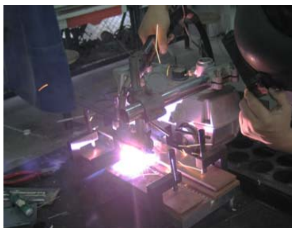
รูปที่ 3.11 แสดงวิธีการเชื่อมชิ้นงาน ด้วยการเชื่อมมิก
