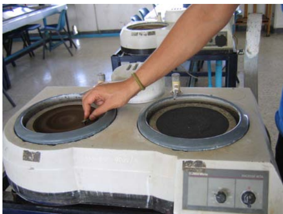
รูปที่ 3.16 แสดงการขัดชิ้นงานทดสอบด้วยเครื่องขัด
