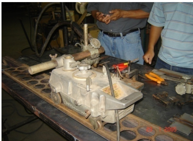
รูปที่ 3.3 เครื่องตัดแก๊สแบบเส้นตรงขับเคลื่อนด้วยมอเตอร์ รุ่น TANATA KT-5N
