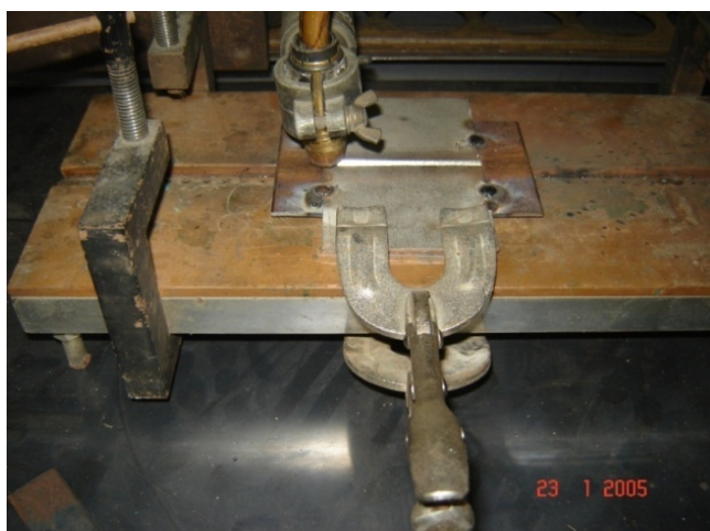
รูปที่ 3.4 อุปกรณ์รองหลังงานเชื่อมและอุปกรณ์จับยึดในงานเชื่อม
