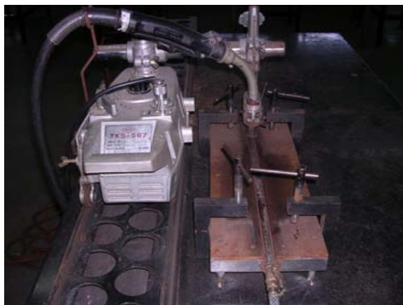
รูปที่ 3.10 แสดงการจับยึดชิ้นงานก่อนการเชื่อมโดยใช้แผ่นทองแดงประกบด้านหลัง
