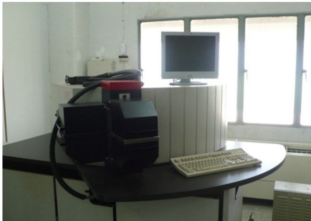
รูปที่ 3.6 เครื่องออปติคอลลิมิซันสเปกโตรมิเตอร์ รุ่น DV 6
