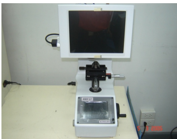
รูปที่ 3.5 เครื่องทดสอบความแข็ง รุ่น MMT-X7
