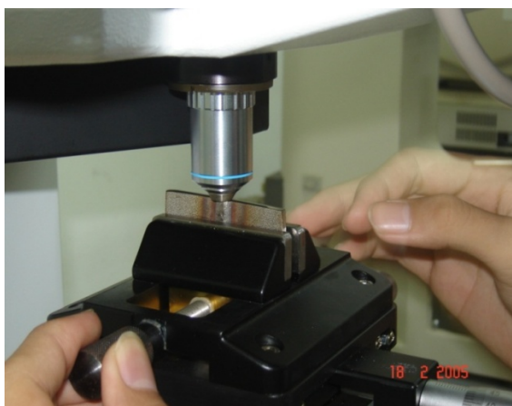
รูปที่ 3.14 แสดงวิธีการทดสอบความแข็งแบบวิกเกอร์ส
