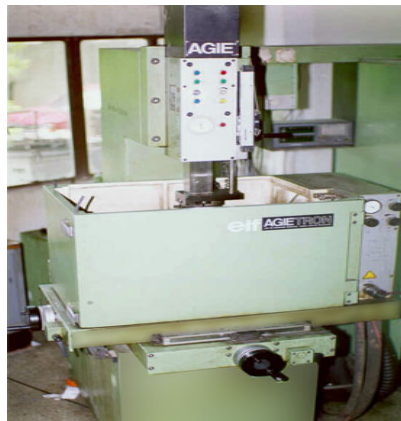
รูปที่ 2.2 แสดงเครื่องกัดเจาะโลหะด้วยตัวนำไฟฟ้า (Electrical Discharge Machining)
