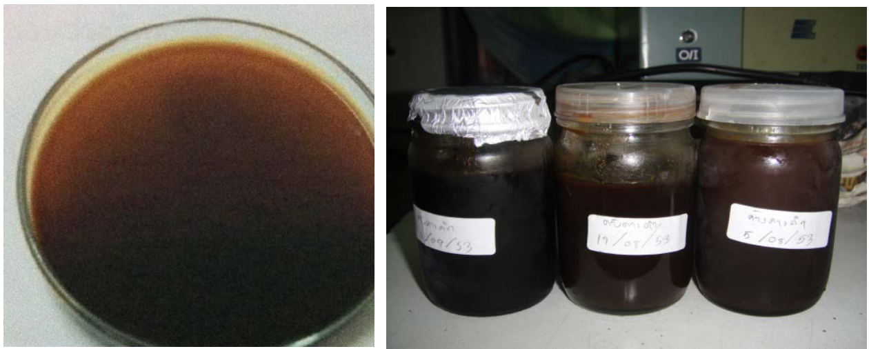
ภาพที่ 14 สารสกัดค้ำควาดำหยาบด้วยวิธี Soxhlet extraction โดยใช้ ethanol เป็นตัวทำละลาย
