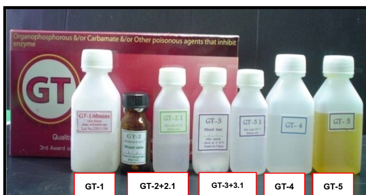
ภาพที่ 26 ส่วนประกอบของชุดทดสอบสารกำจัดศัตรูพืชตกค้าง “จีที”
