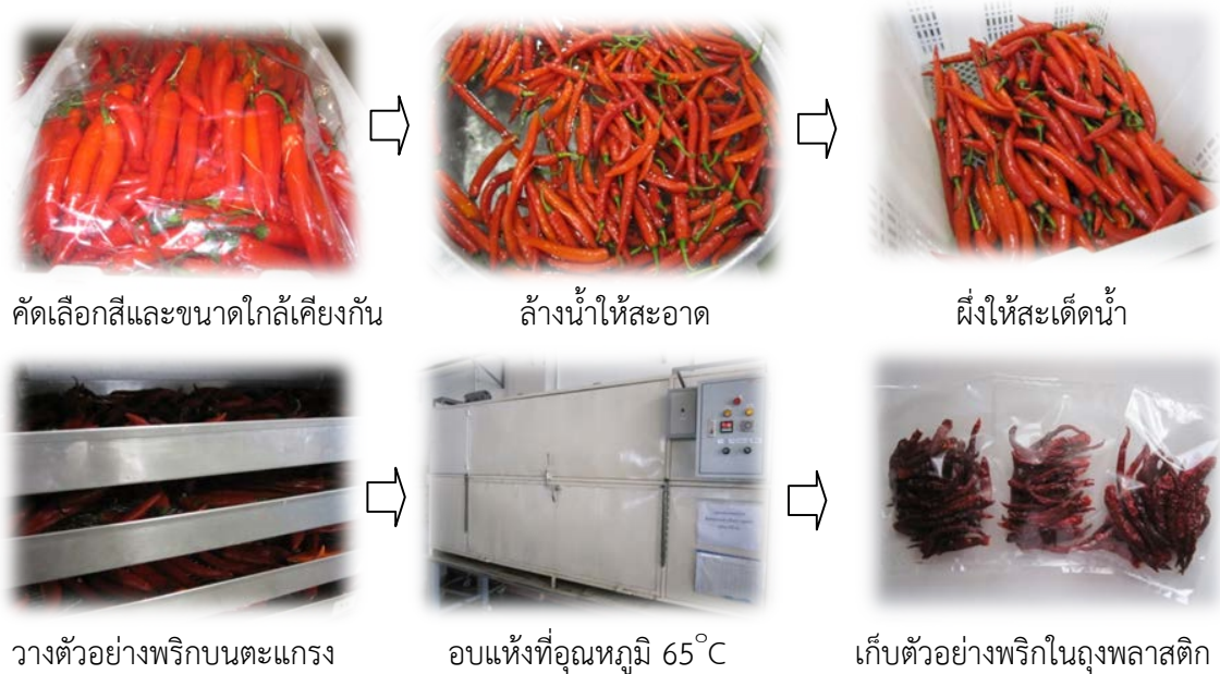
ภาพที่ 38 ขั้นตอนการเตรียมวัตถุดิบพริกก่อนการอบแห้งและกระบวนการอบแห้ง
