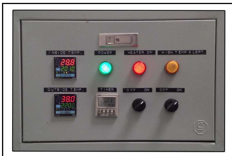
รูปที่ 2-5 ระบบควบคุมและตรวจวัดอุณหภูมิภายในและภายนอกถังปฏิกรณ์ความดันสูง
