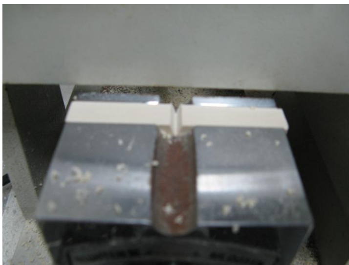
ภาพผนวกที่ ๓3 การทำรอยบากก่อนการทดสอบความทนแรงกระแทก
