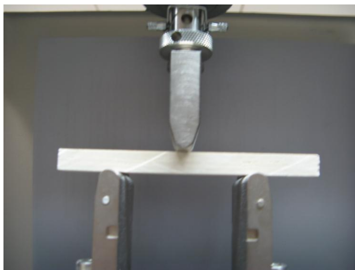
ภาพผนวกที่ ข2 การทดสอบความทนแรงดัดโค้งด้วยเครื่องทดสอบเอนกประสงค์ instron รุ่น 5965
