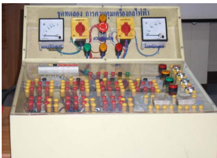
รูปที่ 3.1 ชุดทดลองการควบคุมเครื่องกลไฟฟ้า
