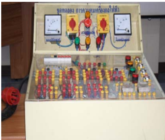
รูปที่ 4.1 แสดงชุดทดลองการควบคุมเครื่องกลไฟฟ้าที่พัฒนาขึ้น
