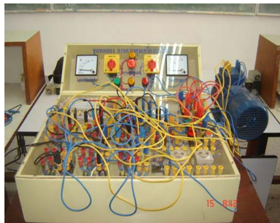
รูปที่ 4.1 แสดงชุดทดลองการควบคุมเครื่องกลไฟฟ้าที่พัฒนาขึ้น
