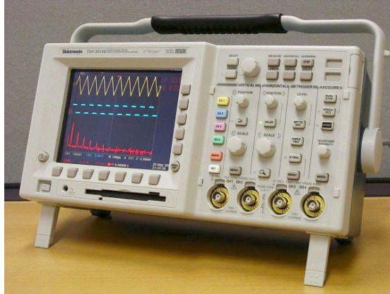
รูปที่ 3.1 แสดงเครื่องวัด Digital Phosphor Oscilloscopes
