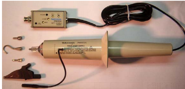
รูปที่ 3.2 แสดง High Voltage Probe วัดแรงดันสูงใช้ร่วมกับ Digital Phosphor Oscilloscopes
