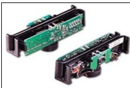
รูปที่ 2.11 ส่วนประกอบของหัวอ่านแถบแม่เหล็ก
