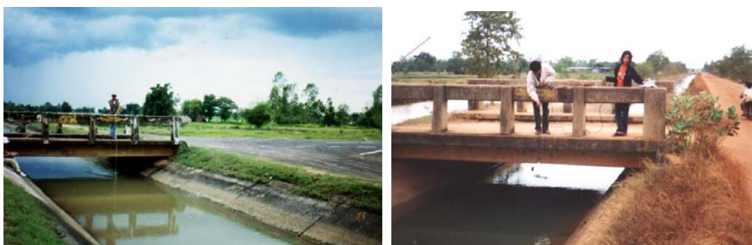
ภาพที่ ก.3 การสำรวจรูปตัด และวัดกระแสน้ำของคลอง 6R-RMC
