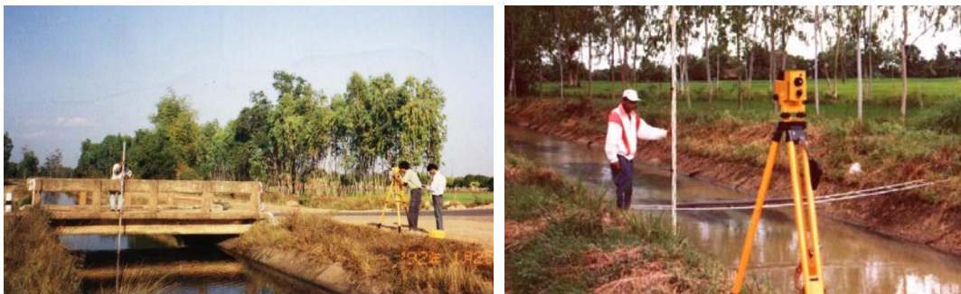
ภาพที่ ก.1 การตรวจวัดรูปตัดทางน้ำของคลองตัวอย่าง 4R-RMC และ 4L-4R-RMC
