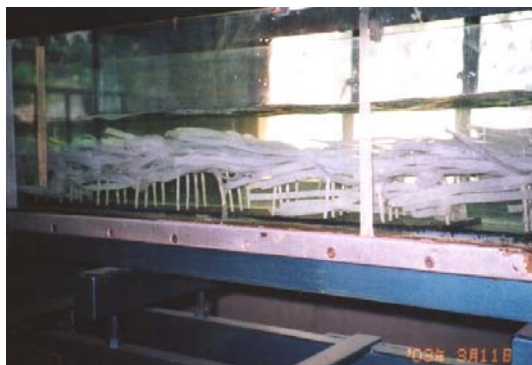
ภาพที่ ณ.2 ลักษณะของวัชพืชจำลอง ในรางน้ำทดลอง
