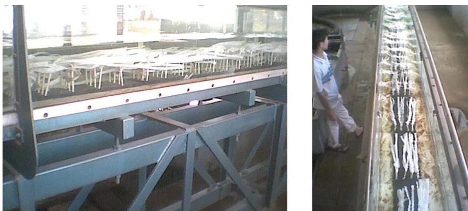
ภาพที่ 4.24 ลักษณะของวัชพืชจำลอง ในรางน้ำทดลอง
