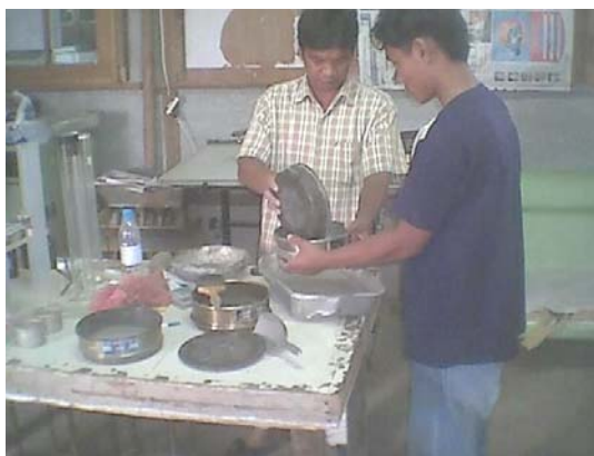
ภาพที่ 4.20 การทดสอบเพื่อวิเคราะห์จำแนกประเภทดินตะกอนตกลมในท้องคลอง
