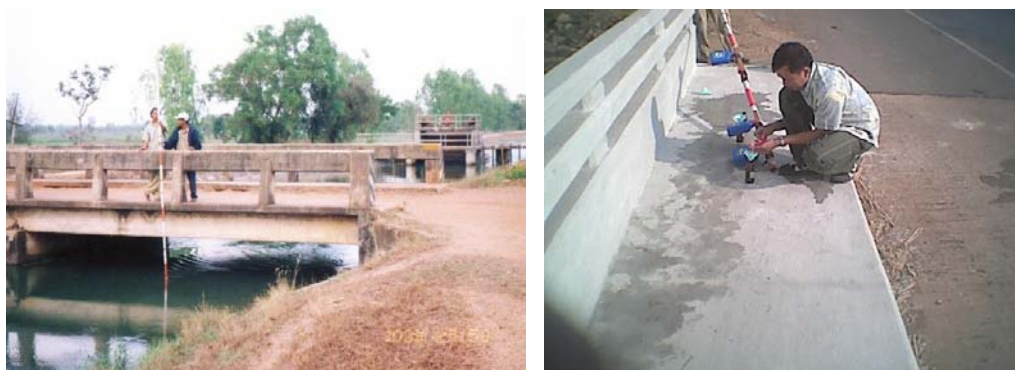
รูปที่ 4.10 การเก็บตัวอย่างน้ำคลอง เพื่อหาปริมาณตะกอนแขวนลอย
