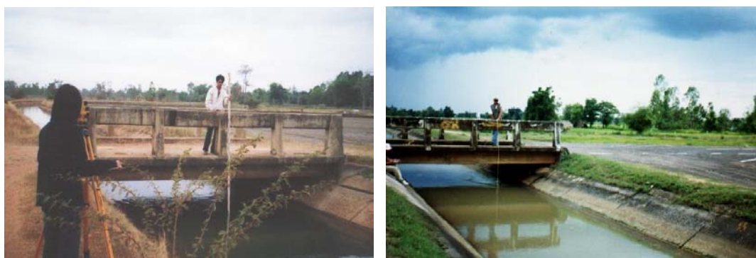
ภาพที่ 4.3 การสำรวจรูปตัดและวัดกระแสน้ำของคลอง 6R-RMC
