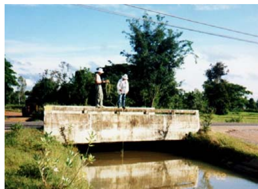
ภาพที่ 4.1 การตรวจวัดระดับผิวน้ำ และวัดกระแสสำหรับคลอง 4R- RMC
