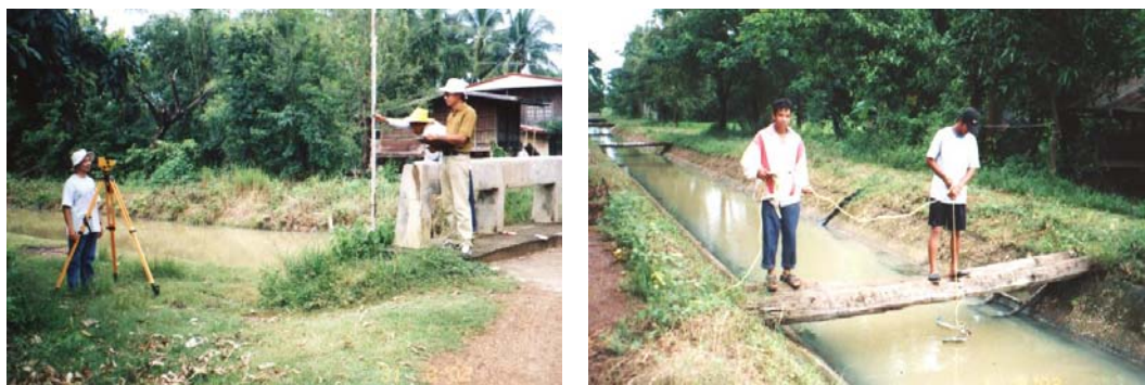
ภาพที่ 4.2 การตรวจวัดระดับผิวน้ำ และวัดกระแสสำหรับคลอง 4L-4R-RMC
