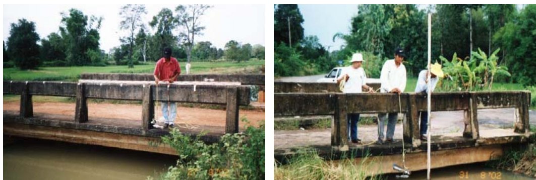
ภาพที่ 3.14 การวัดกระแสน้ำ และอัตราการไหล
