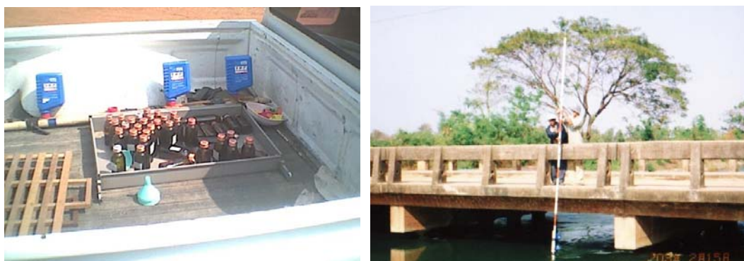
ภาพที่ 3.16 อุปกรณ์เก็บตัวอย่างน้ำคลองและการใช้งานเพื่อการตรวจวัดตะกอนแขวนลอย
