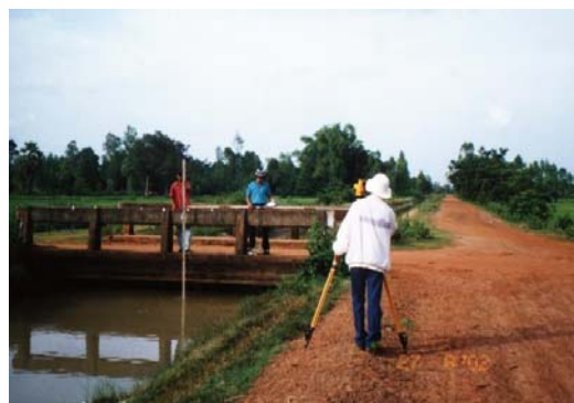
ภาพที่ 3.12 การสำรวจระดับหมุดอ้างอิงชั่วคราวและการวัดหน้าตัดการไหล
