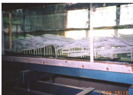
ภาพที่ 3.22 การทดสอบ แบบจำลองการไหลในทางน้ำที่มีวัชพืช
