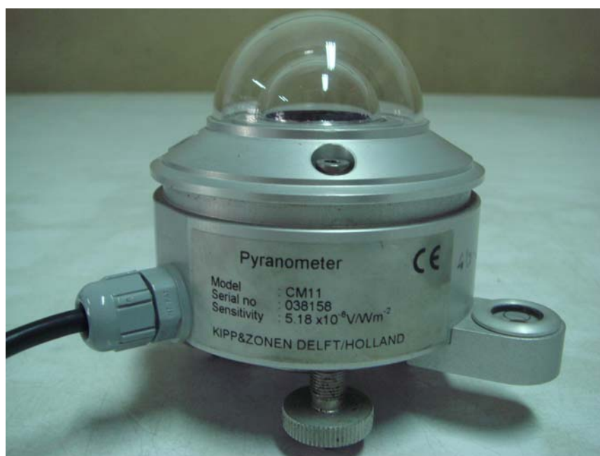
รูปที่ 4.4 แสดงภาพถ่ายไพราโนมิเตอร์ ยี่ห้อ KIPP&ZONEN รุ่น CM11
