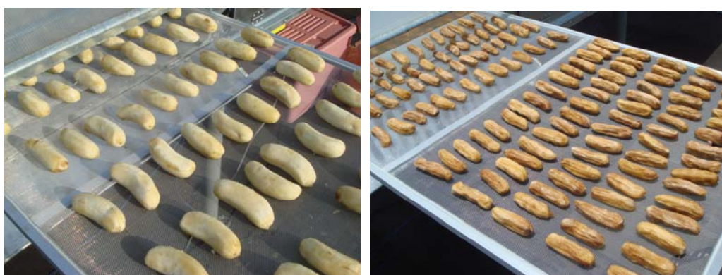
รูปที่ 4.9 แสดงภาพถ่ายกล้วยที่อบอยู่ในส่วนอบแห้งของเครื่องอบแห้ง
