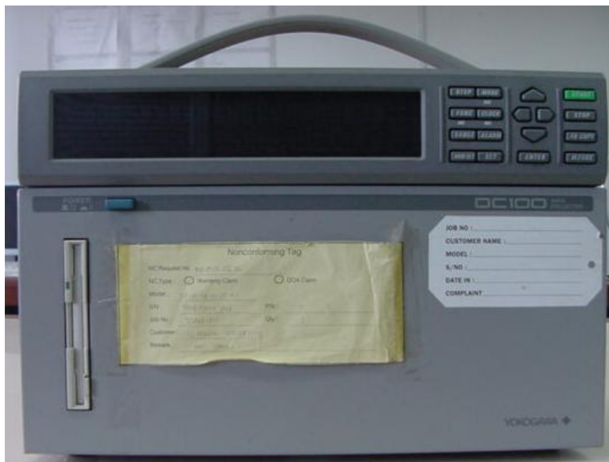
รูปที่ 4.5 แสดงภาพถ่ายเครื่องบันทึกข้อมูล ยี่ห้อ Yokogawa รุ่น DC100
