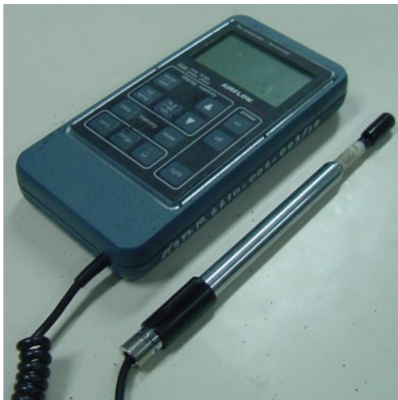
รูปที่ 4.3 แสดงภาพถ่ายเครื่องวัดความเร็วลมแบบ hot wire ยี่ห้อ Airflow รุ่น TA5
