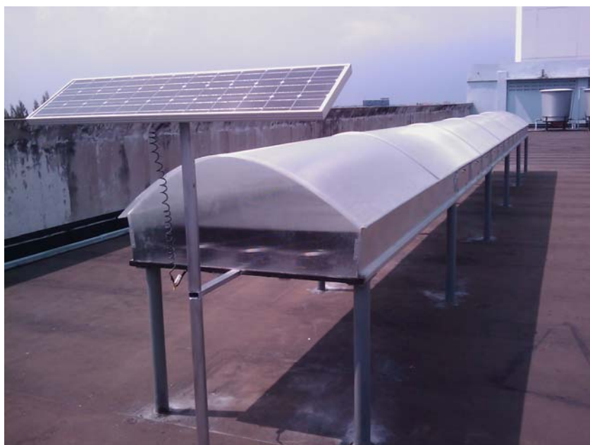
รูปที่ 3.16 แสดงภาพเครื่องอบแห้งพลังงานแสงอาทิตย์แบบอุโมงค์ลมรูปพาราโบลาที่เสร็จสมบูรณ์
