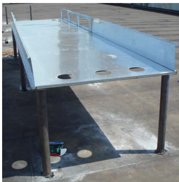
รูปที่ 3.10 แสดงภาพการต่อโครงด้านข้างของแผงรับรังสีดวงอาทิตย์
