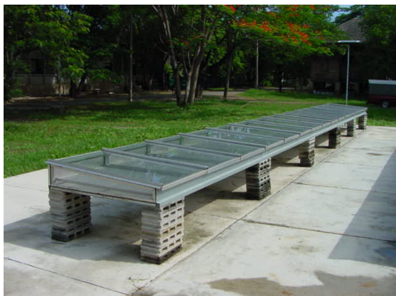
รูปที่ 2.34 แสดงภาพถ่ายเครื่องอบแห้งแบบอุโมงค์ลมที่ใช้แผ่นกระจกใสเป็นฉนวนโปรงแสง พัฒนาขึ้นโดย ชูทศศักดิ์ บุญรอด, (2549)
