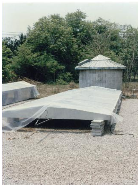
รูปที่ 2.11 แสดงเครื่องอบแห้งแบบรับพลังงานแสงอาทิตย์ทางอ้อมและใช้พัดลมดูดอากาศ
