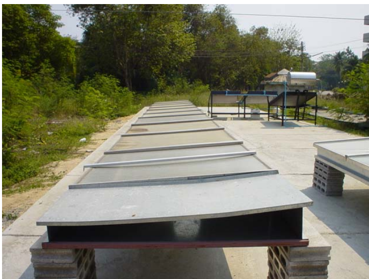
รูปที่ 2.33 แสดงภาพถ่ายเครื่องอบแห้งแบบอุโมงค์ลมที่ใช้แผ่นโพลีคาร์บอเนตเป็นฉนวนโปรงแสง
