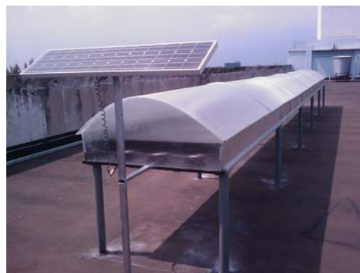
รูปที่ 2 แสดงเครื่องอบแห้งพลังงานแสงอาทิตย์แบบอุโมงค์ลมที่ออกแบบขึ้นใหม่ในงานวิจัยนี้
