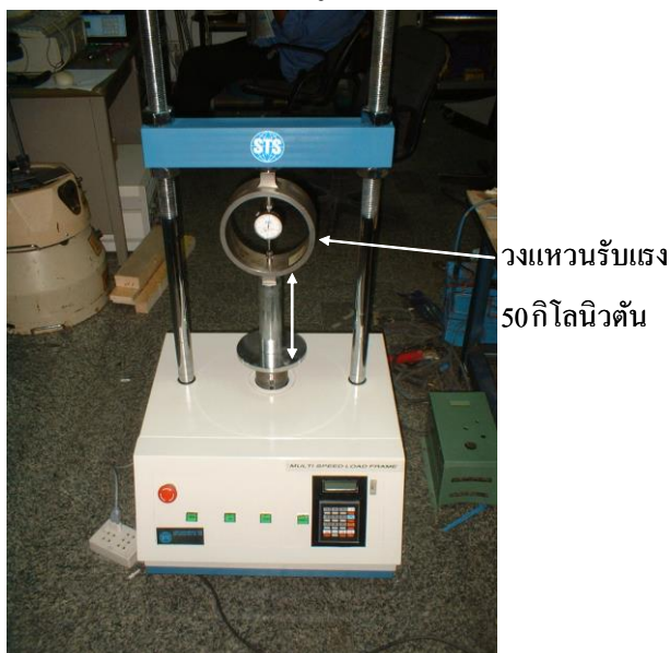
รูป 4.2.1 เครื่องทดสอบกำลังอัดดินกับวงแหวนรับแรง 50 กิโลนิวตัน
