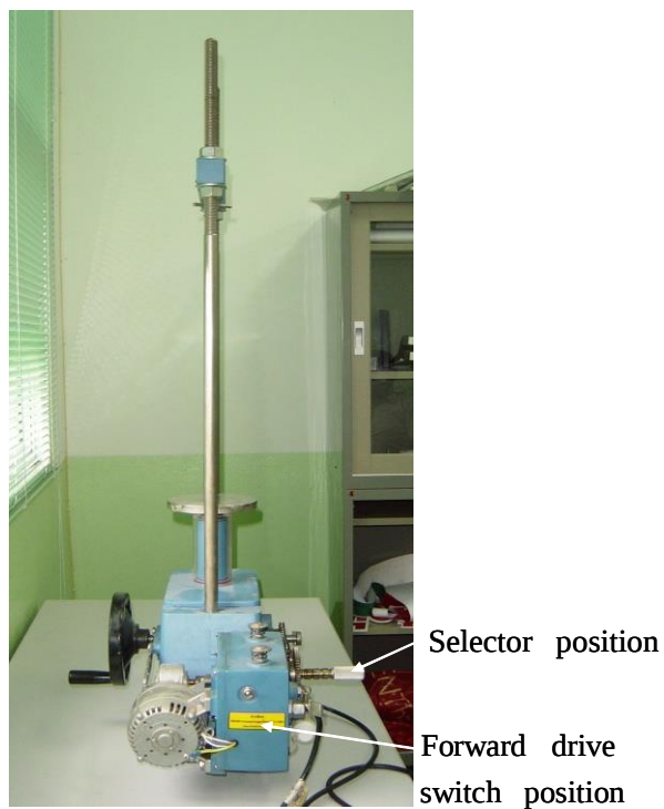
รูป 2.1.4 ตำแหน่ง Selector position และตำแหน่ง Forward drive switch
