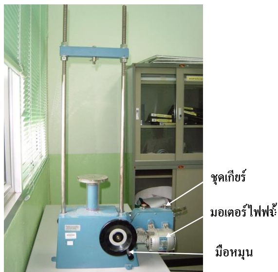
รูป 2.1.3 แสดงโหลดเฟลมแบบสองเสาใช้มอเตอร์ไฟฟ้าหรือใช้มือหมุนก็ได้รุ่นTritest 10 kN
