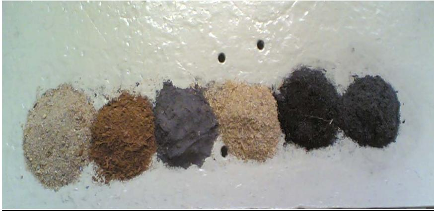
รูปที่ 5.5 แสดงฝุ่นที่นำมาใช้ในการทดลองประกอบด้วย ทรายละเอียด, กากมะพร้าว, กากมะพร้าวเผา, แกลบ, แกลบเผา, กระจายเผา จากภาพทางซ้ายมือ ตามลำดับ
