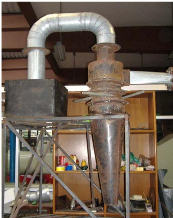
รูปที่ 5.1 ชุดทดลองอุปกรณ์การทดลองไซโคลน
