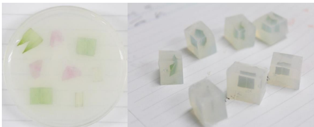
ภาพผนวกที่ 3 การเตรียมตัวอย่างเนื้อเยื่อพืชใน agar 4 เปอร์เซ็นต์ เพื่อใช้สำหรับการตัดเนื้อเยื่อตามขวางด้วยเครื่อง Microslicer รุ่น DTK-1000
