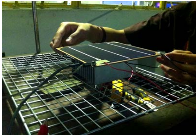
รูปที่3.18 การนำแผงเซลล์แสงอาทิตย์มาติดตั้งลงบนแผ่นทองแดงที่มีเทอร์โมอิเล็กทริกโมดูลติดอยู่กับฮีทซิงค์
