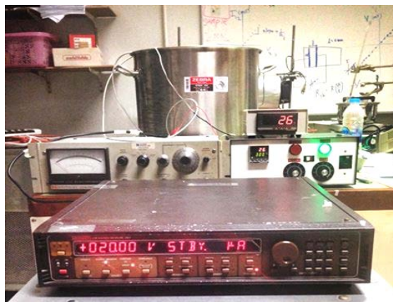
ภาพที่ 3.6 ภาพถ่ายอุปกรณ์ที่ใช้ในการวัดความต้านทานของฟิล์มบางที่อุณหภูมิสูงกว่าอุณหภูมิห้อง
