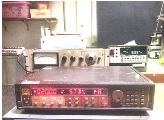
ภาพที่ 3.5 ภาพถ่ายอุปกรณ์ที่ใช้วัดปรากฏการณ์ฮอลล์
