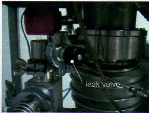
ภาพแสดง leak valve
