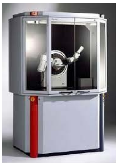
ภาพที่ 3.1 ภาพถ่ายเครื่องเอกซ์เรย์ดิฟแฟรคโตมิเตอร์ ยี่ห้อ Bruker รุ่น D8 Advance
