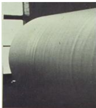
รูปที่ 3.21 ก. ridges จากหนังสือ TAPPI และ ข. ridges ที่พบในกระบวนการผลิตกระดาษ [66]
