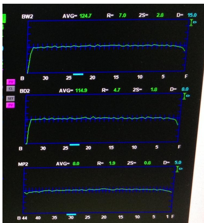
รูปที่ 4.16 หน้าจอควบคุมแสดง profile ของกระดาษเป็นรูปหน้าป้างตามแนว CD ตามเงื่อนไขทดลองที่ 9 (jumbo reel no. 5666)
