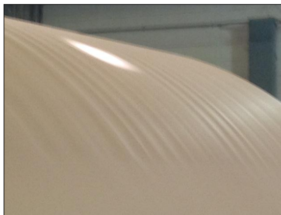
รูปที่ 3.21 ก. ridges จากหนังสือ TAPPI และ ข. ridges ที่พบในกระบวนการผลิตกระดาษ [66]
