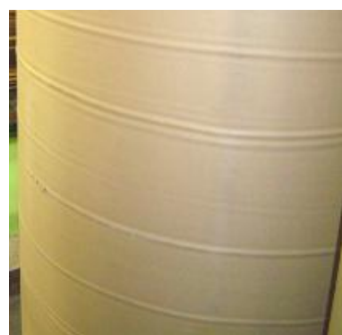
รูปที่ 3.22 ก. moisture welts จากหนังสือ TAPPI และ ข. moisture welts ที่พบในม้วนกระดาษ [66]
