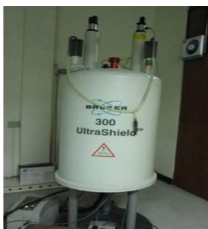
รูปที่ 3.4 เครื่องนิวเคลียร์แมกเนติกเรโซแนนซ์สเปกโตรสโคปี ( ^1\text{H-NMR} )
